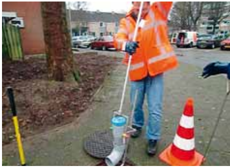
Figuur 5.5 Plaatsing geluidsbron in put
