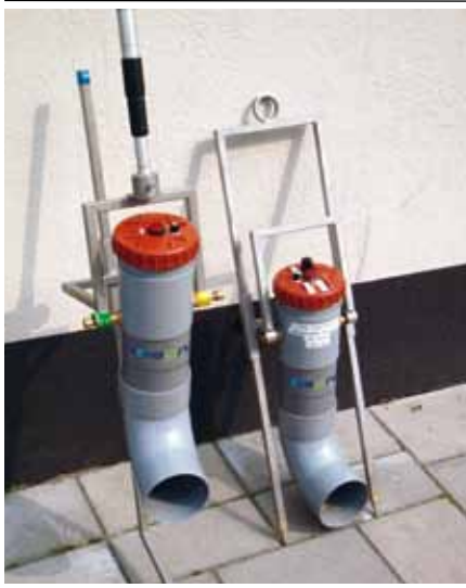
Figuur 5.3 Hulpstukken voor plaatsing geluidsbron in rioolput
