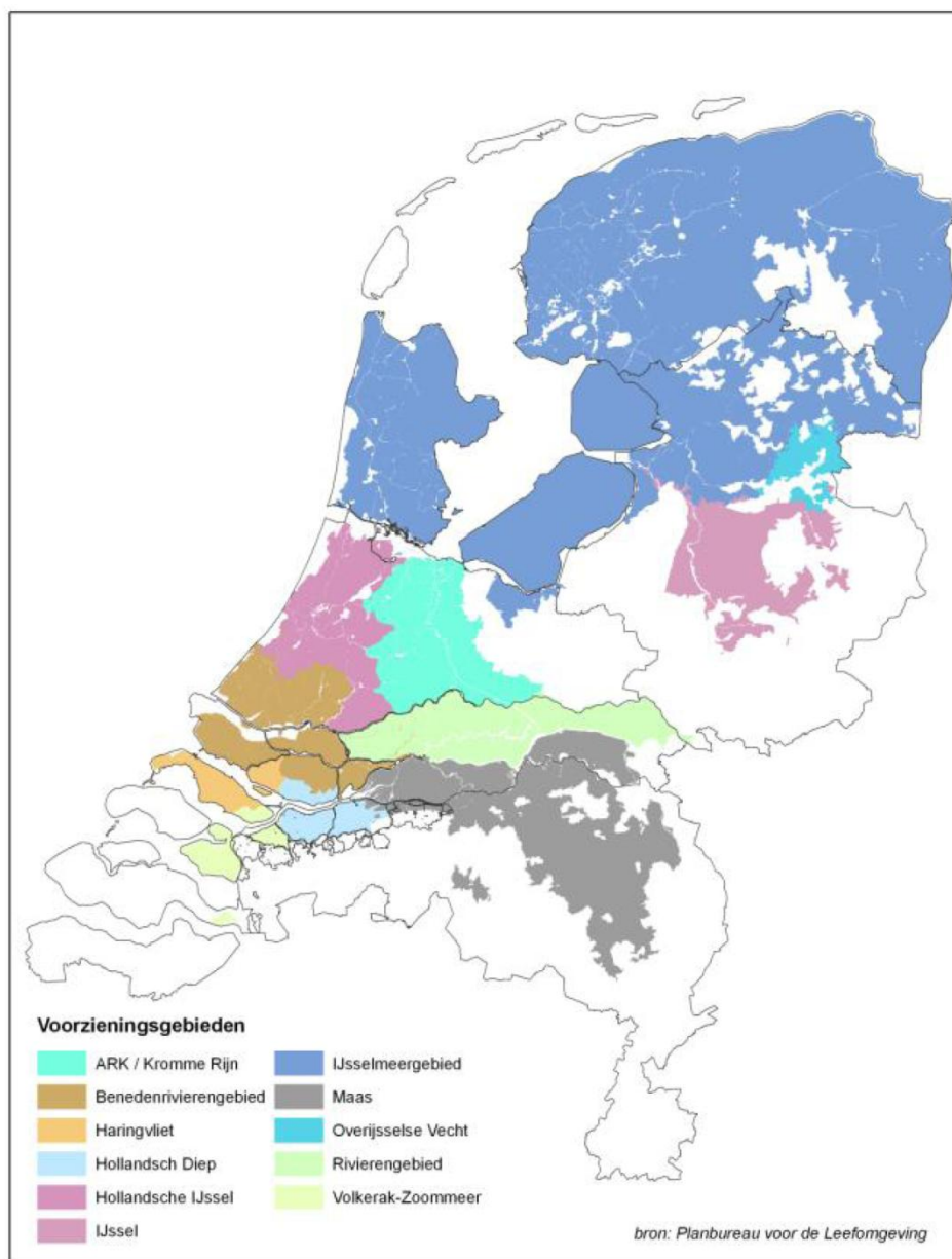
Figuur 3.19 Voorzieningsgebieden zijn peilbeheerste gebieden die van oppervlaktewater kunnen worden voorzien (bron: Deltares, 2011).
