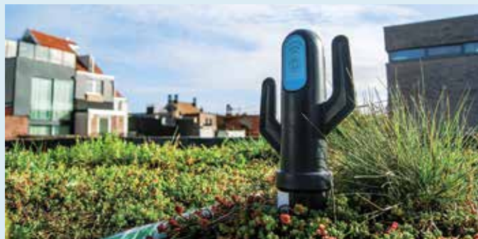
Sensor om de waterhoogte in de onderliggende waterbuffer te meten. (Foto: Vincent Wolfs)
