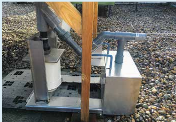
Detail van de opstelling om de afstroming van groendaken te meten met twee pluviometers. (Foto: Vincent Wolfs)
