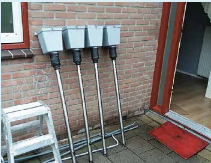
Afvoermeetbuizen met opvangbak. (Foto: Hendrikjan Teekens)
