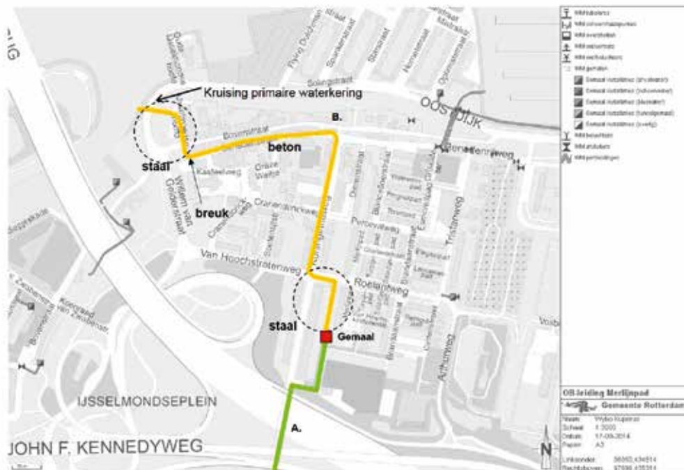
Figuur 3.8 Locatie leidingbreuk en materialen persleiding
