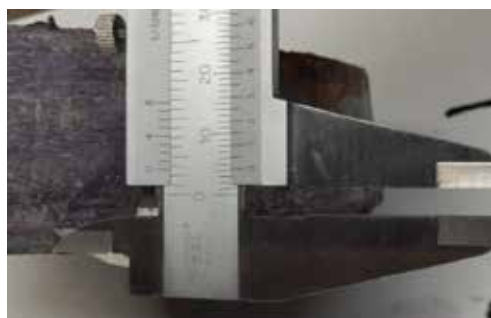
Figuur 5.9 Voorbeeld boorkernonderzoek. Links: wanddiktemeting. Rechts: Meting uitloging (4,3 mm). Uit: Striper, P en Dijkstra, R. (2014). Hoogheemraadschap Hollands Noorderkwartier. Bevindingen initiële AC-inspectie.
