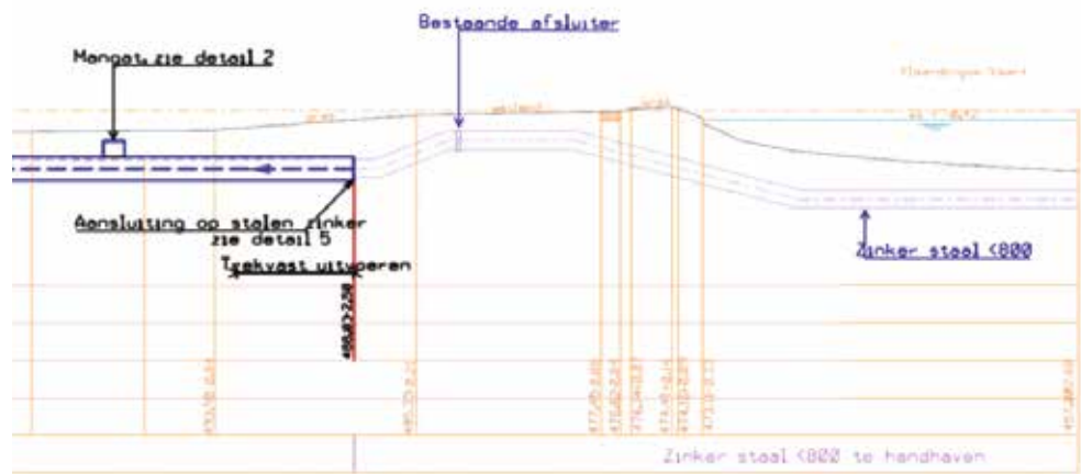
Figuur 3.26 Detail overgang bestaande zinker ter plaatse van de Vlaardingse Vaart. Volgens het beheersysteem is deze zinker vervangen, terwijl de tekeningen aangeven dat de leiding is behouden.
