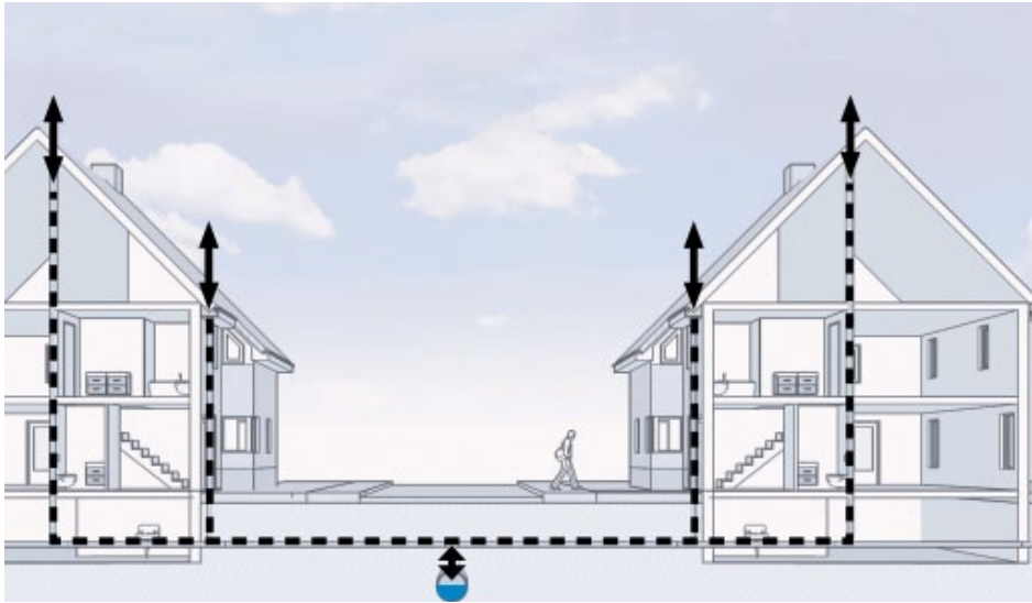
Figuur 17.11 Be- en ontluftung in overige woningen
