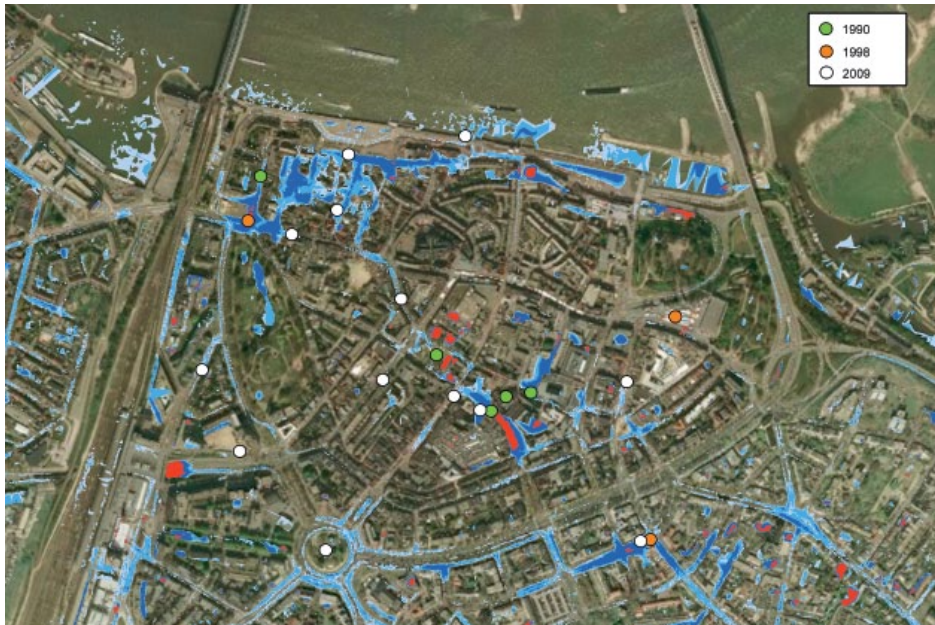
Figuur 16.4 Vergelijking neerslaggebeurtenissen centrum Nijmegen met 2D-modellering (Bron: Grontmij, Wodan-2D-analyse 24-9-13).
