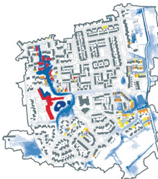
Figuur 2.2 Visualisatie 2D-berekening situatie vóór aanleg bergingsvoorzieningen.
