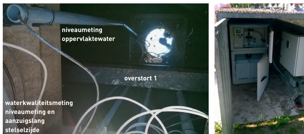
Figuur 2.11 Niveau- en waterkwaliteitssensoren bij overstort 1 (locatie A, links) en monsternamekast in vandalisme-bestendige behuizing (rechts)
